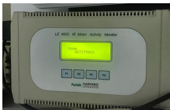
Рис. 3. Контрольная панель для оценки поведенческих реакций на аппарате Actimeter модель LE8825 компании Panlab Harvard Apparatures
