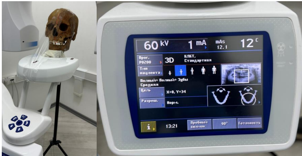
Рис. 2. Выполнение конусно-лучевой компьютерной томографии скелетированного черепа Fig. 2. Cone-beam computed tomography of the skeletonized skull
