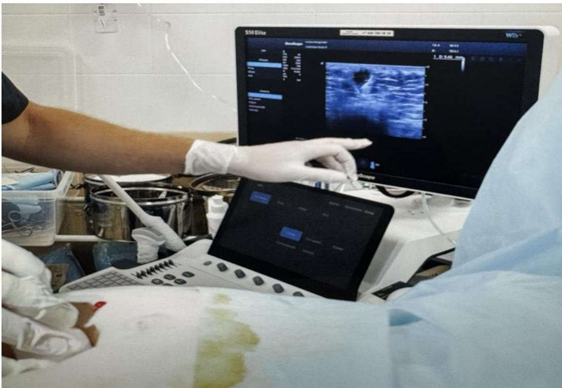
Рис. 1. Аппарат SonoScape S50 Elite. Диапазон рабочих частот: 1–17 МГц
