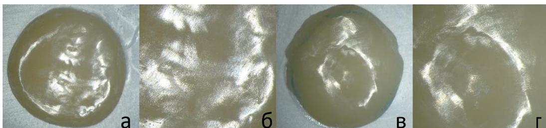
Рис. 7. Поверхность образцов материала I, обработанных головкой из системы Opti 1 Step Polisher Kerr
