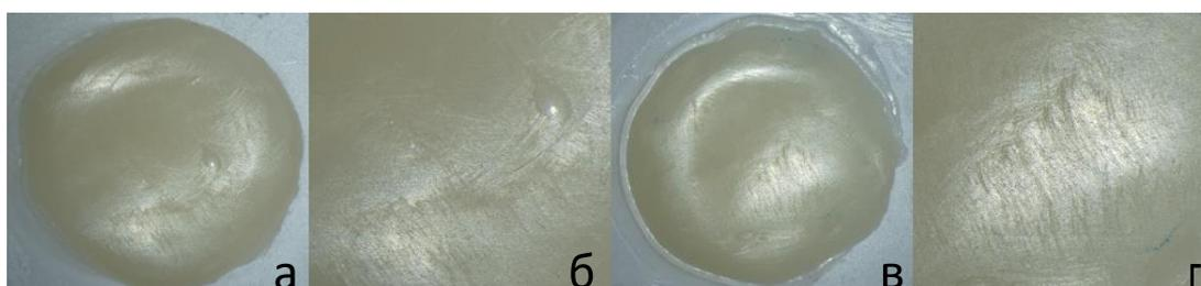
Рис. 4. Поверхность образцов материала II, обработанных шлифовальными дисками «ТОР ВМ»
