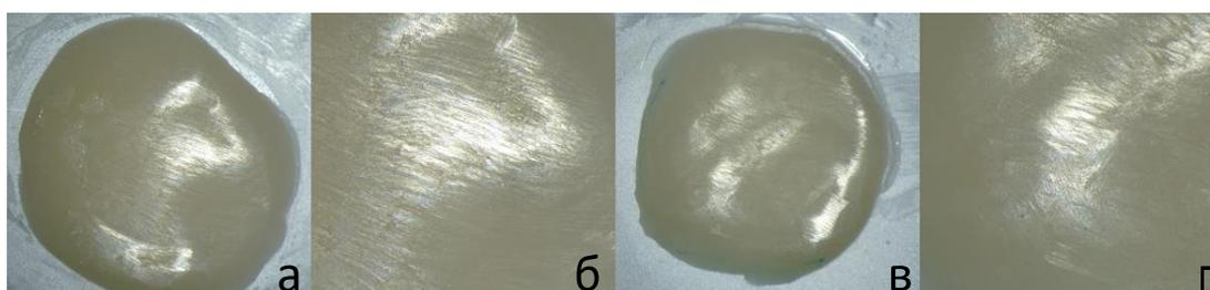
Рис. 3. Поверхность образцов материала I, обработанных шлифовальными дисками «ТОР ВМ»
