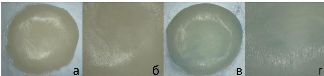
Рис. 6. Поверхность образцов материала II, обработанных головкой Enhance
