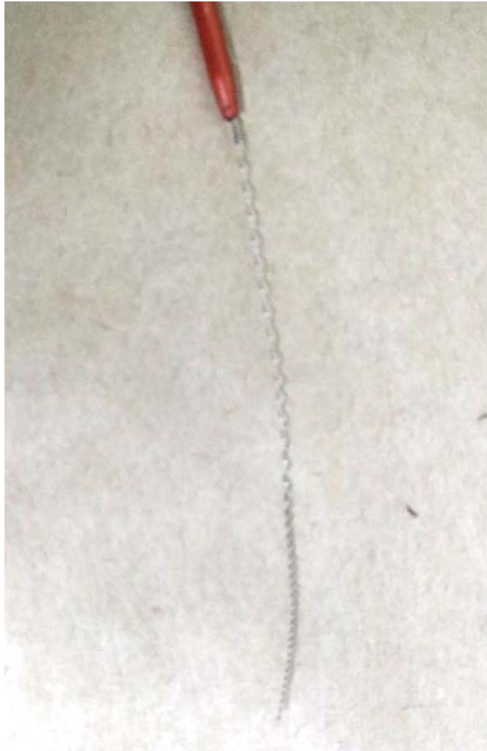
Рис. 4. Каналонаполнитель после механической обработки. Спираль деформирована, растянута Fig. 4. Channel filler after machining. The spiral is deformed, stretched
